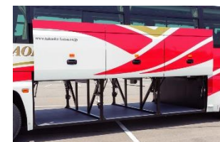
貫通式トランクルーム
